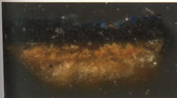
Fig.72 | Batismo de Cristo . Corte estratigráfico da amostra nº 19 (110X) em que se pode observar uma fina camada de azurite, aplicada sobre um estrato cinzento-escuro que, por sua vez, se encontra sobre a preparação.
